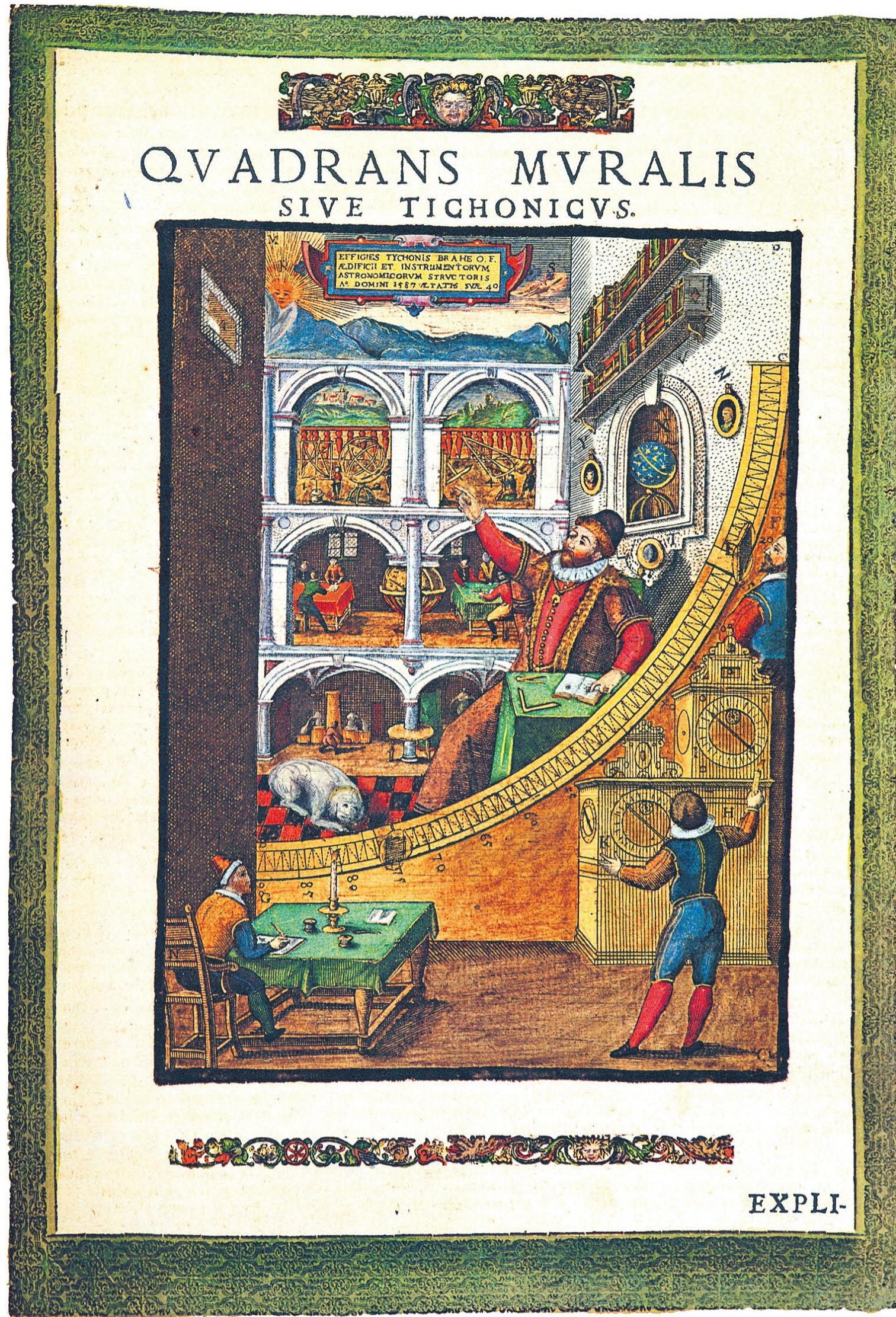
EN SIDE fra bogen "Astronomiæ instauratæ Mechanica" som Tycho Brahe skrev og hvori han nøje beskriver sine fine instrumenter til observation af stjernernes placering og bevægelser. Her en "Quadrans Muralis" eller mur-kvadrant i fem tommer ren messing. På linket http://kortlink.dk/6x7c kan man læse hele bogen med hans egne ord.
